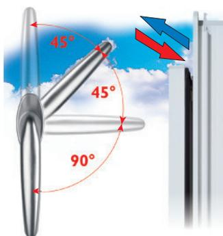
Esta manilla posee un tope adicional a 45° para una posición de oscilo de entre 10 y 13 mm. De esta manera se asegura el funcionamiento óptimo del compás de aireación.
